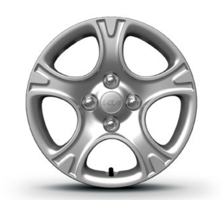
Jantes en acier 14" avec pneus 175/65 R14 (de série sur Pure) 14" stalen velgen met 175/65 R14 banden (standaard op Pure)
